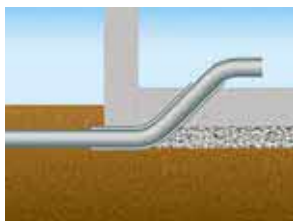
配管を二重にすることで、補修・交換を容易にした排水管の例
